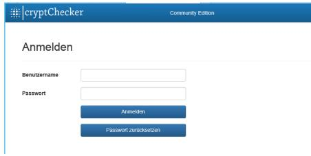
Die Standard Installation des cryptChecker Servers erfolgt in http und auf Port 8765. Bei Bedarf kann die Web Applikation auf https und einen anderen Port geändert werden. Bitte beachten Sie, dass dann die Client Installation entsprechend angepasst werden muss.
